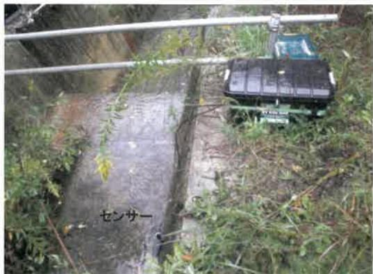
平成 24 年 10 月 23 日 水位計測センサー設置状況
