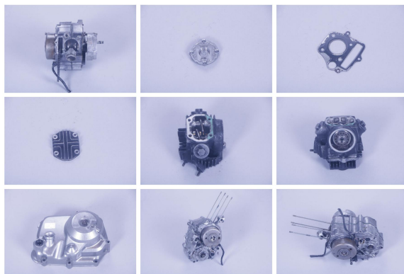
図 3. エンジンの分解後の構成
