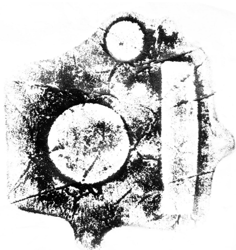
図7.ヘッドガスケットの拓本
